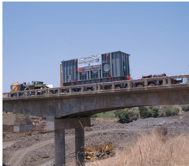
● Fig. 15 - Il passaggio del trasformatore sul ponte. ● Fig. 15 - The transformer crossing the bridge.
