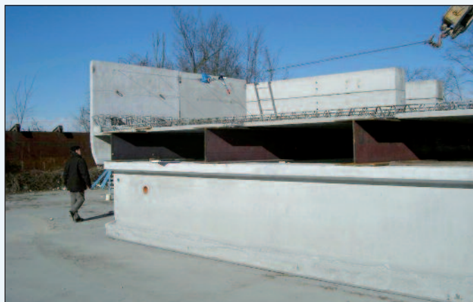
Figura 8 - La prova del sistema di attacco predalle - veletta
