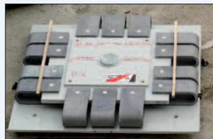
Figura 11 - Un ritegno elasto-plastico bidirezionale per le pile fisse del Tammaro I
