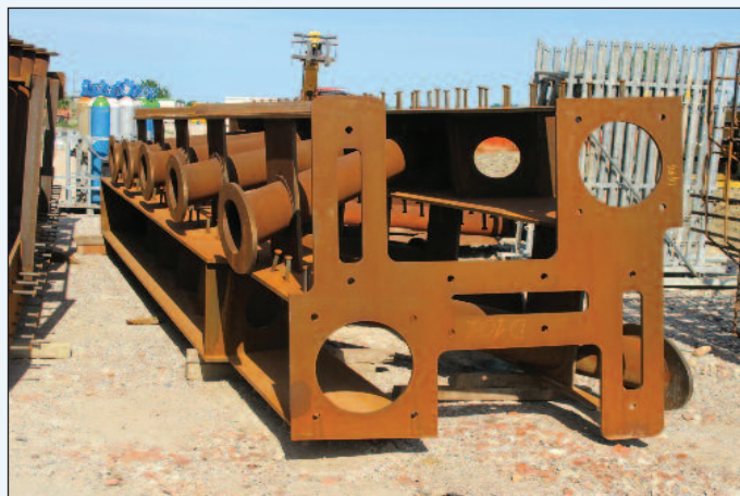
8. Gli ancoraggi degli stralli in testa antenna
