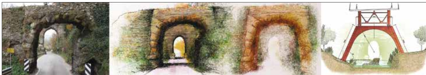
5. Il percorso di metamorfosi: dall'arco romano in muratura alla pila a cavalletto in acciaio Cor-Ten
